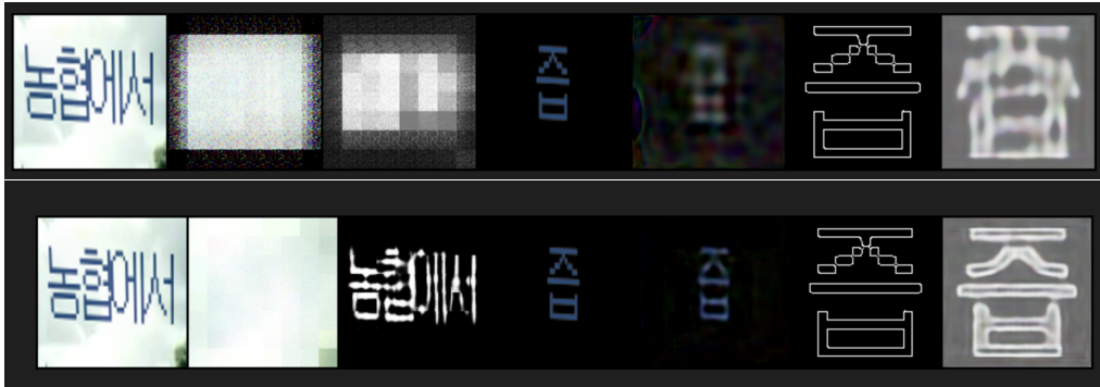
Figure 2.4: 왼쪽부터 순서대로 각각 source_image (입력 텍스트 이미지), removal_image (텍스트 제거 결과), seg_image (텍스트 분할 결과), color_gt (색상 전송 대상 텍스트), color_image (색상 전송 결과), font_gt (폰트 전송 대상 텍스트), font_image (폰트 전송 결과)를 나타낸다. 위의 그림은 첫 에폭시, 아래의 그림은 에폭 50이후의 이미지이다.
